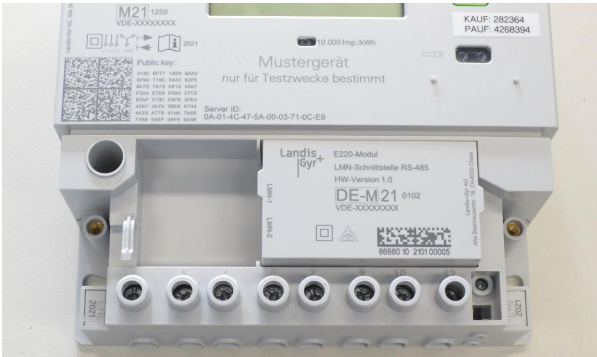
Zähler mit eingefügtem Modul / Meter with mounted module
