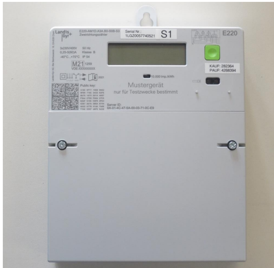
Zähler mit Klemmendeckel / Meter with terminal cover
